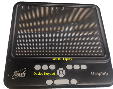
Abbildung 2.3: Taktiler Display von Graphiti, bestehend aus 60×40 aktualisierbaren Pins, die eine Meereswelle darstellen [HABDS + 22]
